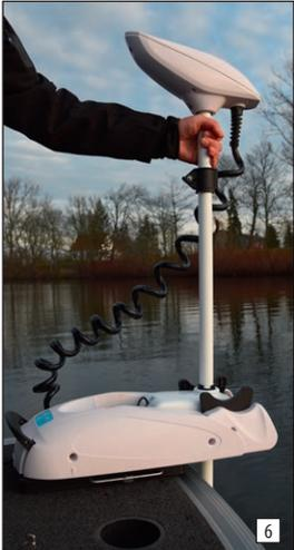
Den Motorschaft mit einer Hand festhalten, dann die Schraube an der Tiefeneinstellung lösen und den Motor auf die gewünschte Tiefe justieren.
