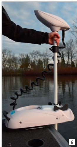
Tenere l'albero del motore con una mano, quindi allentare la vite di regolazione della profondità e impostare il motore alla profondità desiderata.
