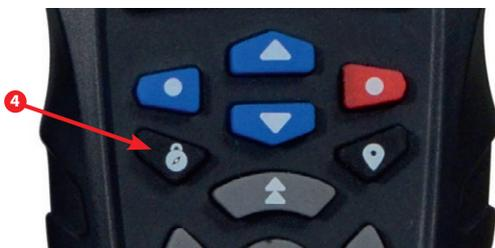
• le mode pilote est activé en appuyant sur la touche 4 (symbole boussole) et peut ensuite être paramétré dans le menu « Fix Mode » entre :
