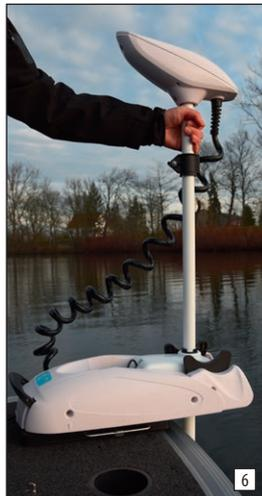
Trzymaj kolumnę jedną ręką, a następnie poluzuj śrubę i ustaw pożądaną głębokość zanurzenia. Włącz regulację głębokości w układzie sterującym (fot. 6), a następnie dokręć. Wyrównaj głowicę silnika jeśli jest to konieczne.
