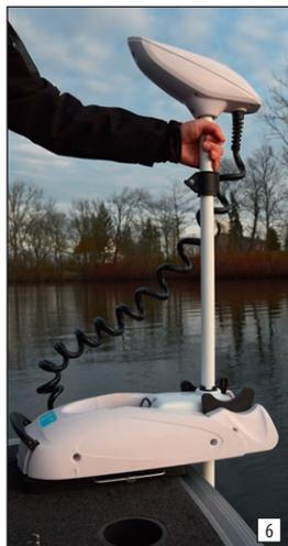
Jednou rukou pevně podržte tyč motoru, poté uvolněte šroub k nastavení hloubky a umístěte motor do požadované pozice.
