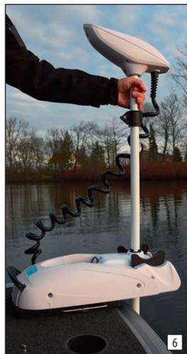
Houd de stang van de motor met een hand vast, draai dan de draaiknop los waarmee de hoogte vastgezet wordt en zet de motor op de gewenste diepte.
