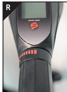
5. Avant de redémarrer, il est nécessaire de remettre la poignée en position zéro après l'étalonnage le recalibrage est terminé.
