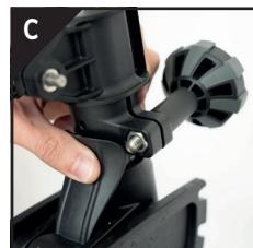
Za podešavanje kuta ugradnje, jednom rukom držite glavu motora, a drugom rukom pritisnite polugu za pozicioniranje (SLIKA. C) prema osovine. Držite ručicu dok se ne postigne željeni kut. Otpustite ručicu i provjerite je li mehanizam za pričvršćivanje motora čvrsto pričvršćen.
