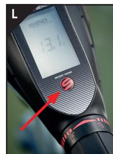
2. Forgassa el a fogantyút az óramutató járásával megegyező irányba a maximális helyzetbe. Ezután nyomja meg ismét az S gombot.
