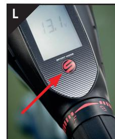
2. Tournez la poignée dans le sens des aiguilles d'une montre jusqu'à la position maximale, appuyez ensuite à nouveau sur la touche S.
