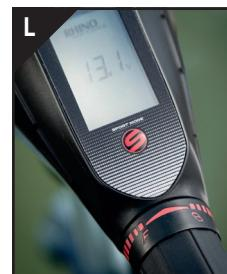
2. Gire la empuñadura en el sentido de las agujas del reloj hasta la posición máxima, A continuación, vuelve a pulsar el botón S.
