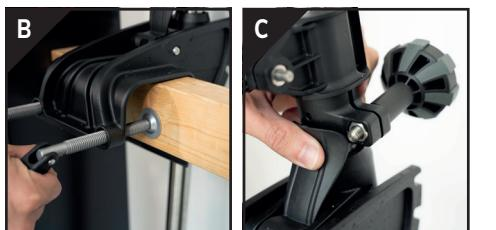
Aby wyregulować kąt nachylenia, należy jedną ręką przytrzymać głowicę silnika, a drugą nacisnąć dźwignię pozycjonującą (RYC. C) w kierunku kolumny silnika. Przytrzymuj dźwignię, aż zostanie osiągnięty żądany kąt. Zwolnij dźwignię i upewnij się, że mechanizm mocowania silnika jest zablokowany..
