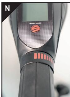
4. Rotiți maneta comutatorului în sens invers acelor de ceasornic până la poziția maximă, Apoi apăsați din nou butonul S.
