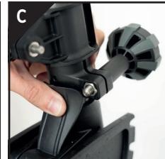
Pro nastavení sklonu motoru držte hlavu motoru jednou rukou a druhou rukou stiskněte polohovací páku (OBR. C) směrem k noze motoru. Páku podržte stisknutou, dokud není dosažen požadovaný úhel. Poté uvolněte páku a ujistěte se, že mechanismus uchycení motoru je pevně zavaknut.
