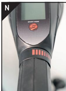
4. Otočte rukojetí spínače proti směru hodinových ručiček do maximální polohy. Poté znova stiskněte tlačítko S.
