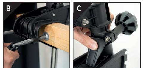
Pentru a ajusta unghiul de montare, țineți capul motorului cu o mână și apăsați pârghia de poziționare (FIG. C) spre ax cu cealaltă mână. Țineți apăsată pârghia până când se atinge unghiul dorit. Eliberați pârghia și asigurați-vă că mecanismul de montare a motorului este fixat ferm.
